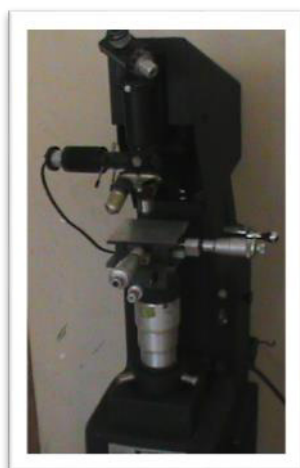
Figura 12. Durómetro Wilson Tukon ubicado en el laboratorio de análisis de mecánica de la Escuela Politécnica Nacional del Ecuador.
